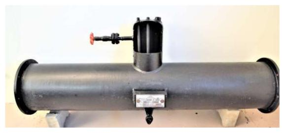
Die Anlage konnte aus Platzmangel im Frigotheum nicht originalgetreu aufgebaut werden, deshalb wurde nur der Kompressor mit Antrieb aufgebaut. Zur Demonstration des Rohrbündelwärmetauschers wurden die beiden Umlenkkappen entfernt und der Dom geöffnet.
