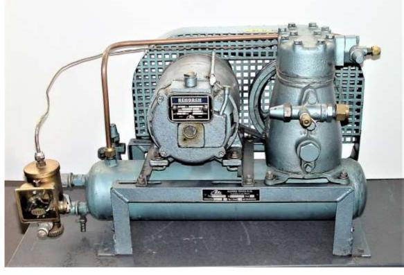
Zubehör: Kühlwasserregler Herion mit KWR ½ Zoll Quecksilber Druckschalter.
