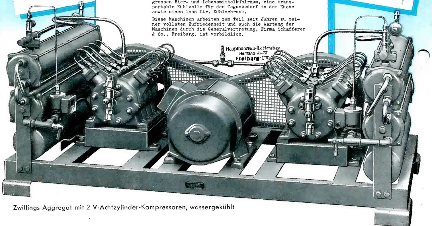
Zwilling-Aggregat mit 2 V-Achtzylinder-Kompressoren, wassergekühlt
