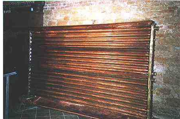
Rieselkühler zur Würzekühlung – oben mit Brunnenwasser, unten mit Eiswasser
