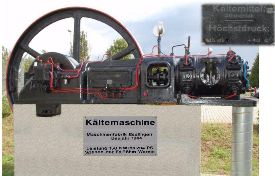
**Technische Daten des Verdichters:** Liegender doppelwirkender Ammoniak Kältemittelverdichter mit Kreuzkopf und Zentralschmierung, Leistung ca. 150 KW.
