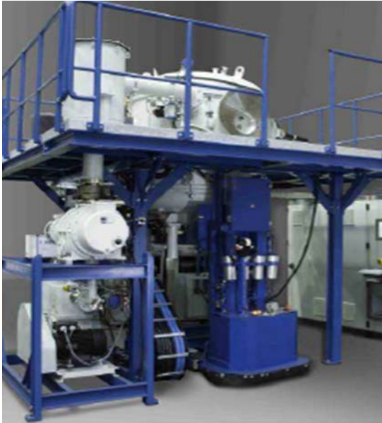
Blockkristallisation von mc-Si (250 kg)
