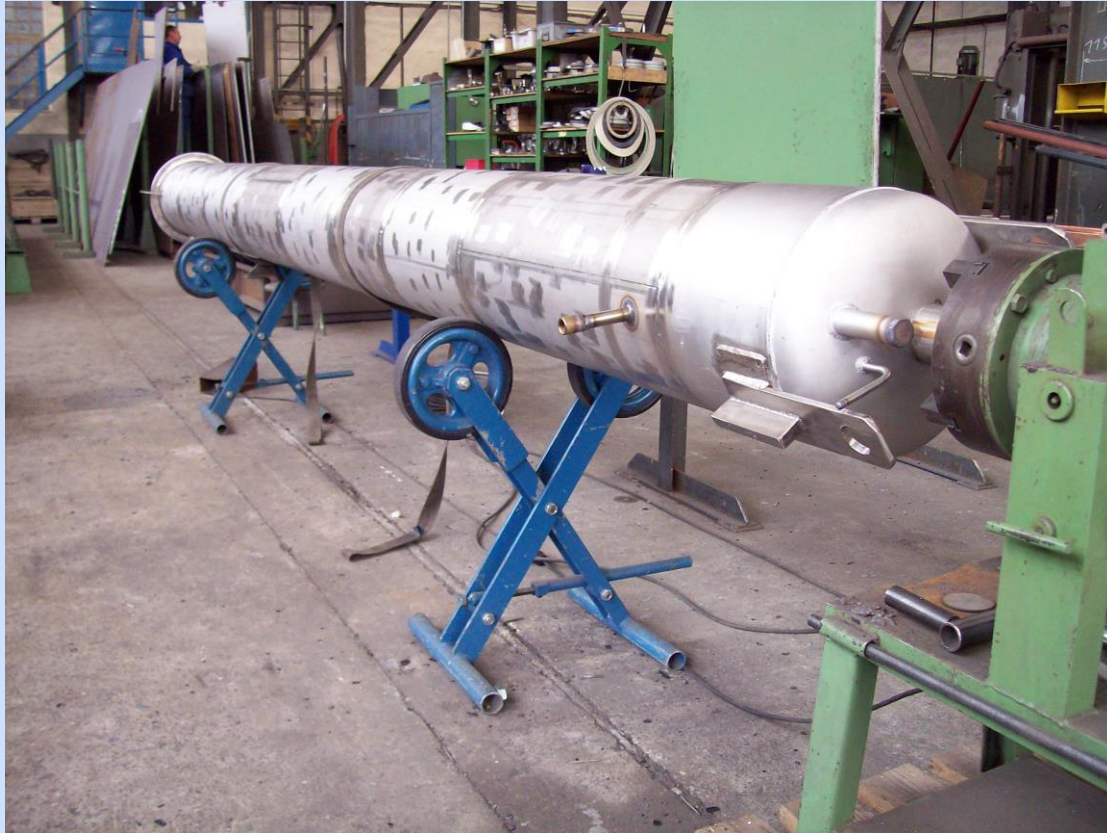
Fertigung einer Siebboden-Rektifikationssäule (Bild 31)
