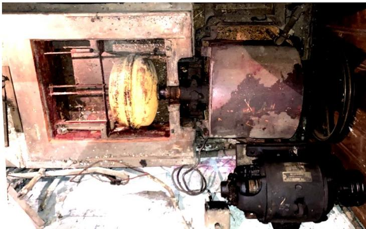
Bei der Besichtigung konnte die Abdeckung der Verdampferseite abgenommen werden – die der Verdichterseite leider nicht – die Verschraubungen waren total festgerostet. Die Maschine selbst scheint noch völlig in Ordnung – beim Durchdrehen der Maschine von Hand, waren
