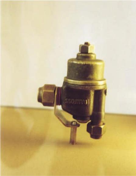
*Mads' Patent: Die Erfindung eines „dänischen“ Expansionsventils war eigentlich die druckgesteuerte Version, das ARV; abgedrückt wurde mittels Hand/Fußluftpumpe in Mutters Zinkwanne im Wasserbad, um die Ventildichtungen zu prüfen*
