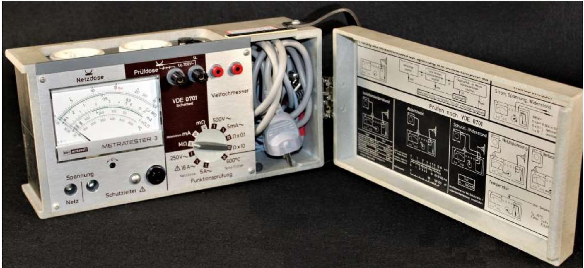
Das war Standardausrüstung für viele Monteure. Ein verlässlicher Erdungstester für alle Kleingeräte. Kleiner Tipp: bei vorhandenem FI- Schutzschalter fliegen die Sicherungen.
