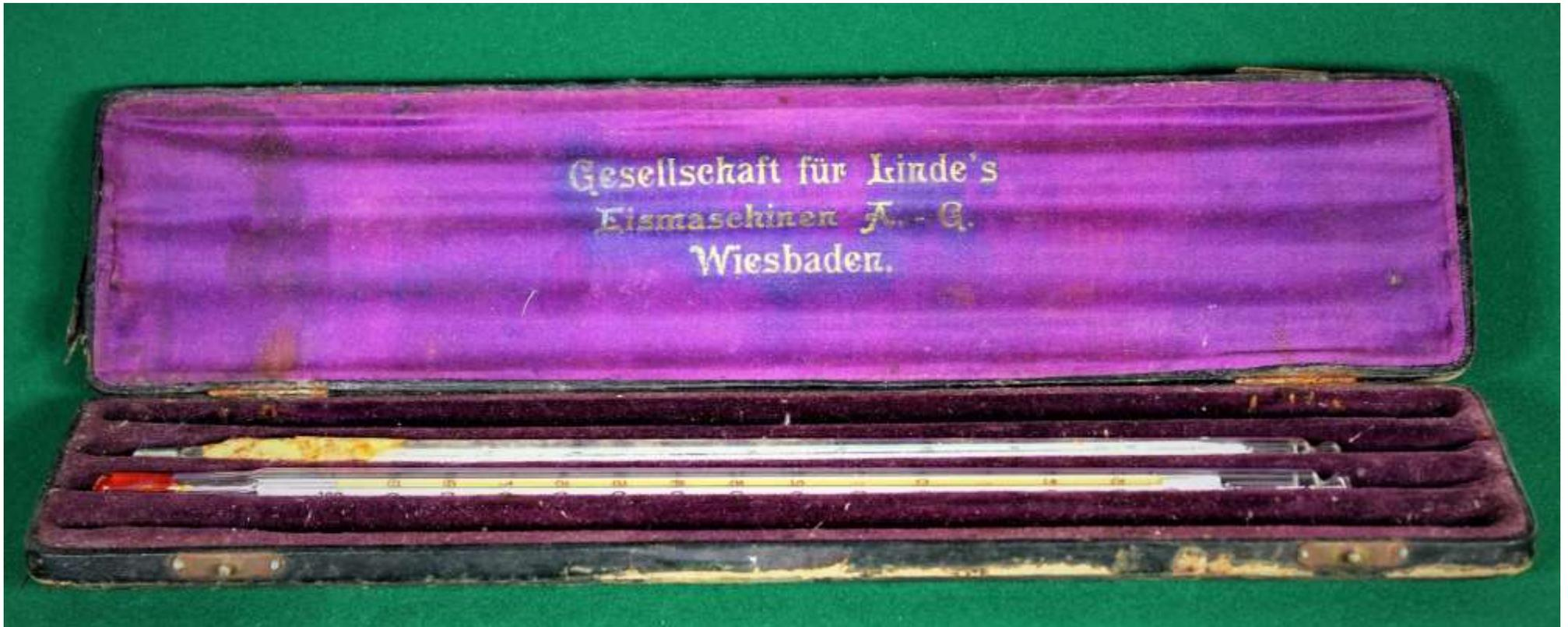
Bei einer Temperatur von 30 °C und 50 % relativer Luftfeuchtigkeit wird das Feuchtkugel-Thermometer auf 22 °C abgekühlt - siehe hierzu: [Thermodynamische Grundlagen](#)
