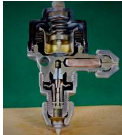
Schnittmodell Leistungsregler LR 12
