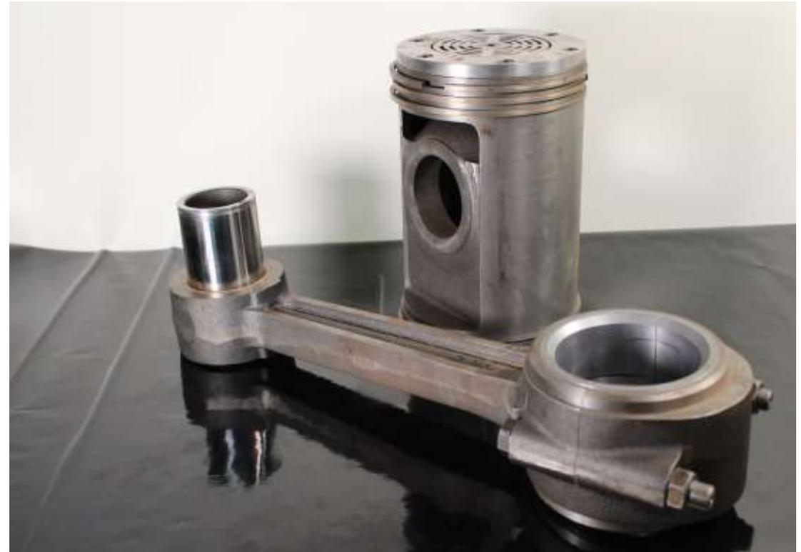
Das Geschäft des Unternehmens mit Industrie- und Großkälteanlagen belebte sich nach 1945 wieder. Als Verdichter wurden die bewährten, Vorkriegs-Baureihen „ARE“ wieder geliefert. Es handelt sich um offene, langsamlaufende (max. 600 U/min), 2- und 4- Zylinder- Verdichter mit stehender Zylinderanordnung für Kälteleistungen von 1200 bis 650.000 kcal/h. Verdichter für Chlormethyl wurden für 300 bis 58.000 kcal/h gebaut.
