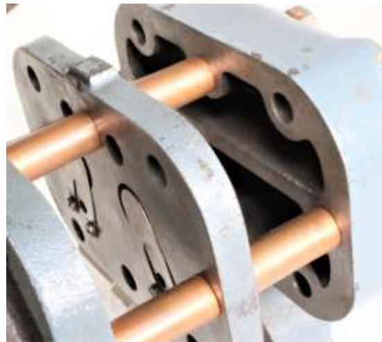
Dieser Verdichter Typ SLC löste 1957 die Rollkolbenverdichter u.a. in Kühlschränken H90 und H125 ab, bevor 1959 Hermetikverdichter verfügbar waren. Das geschah im Zusammenhang mit der Einführung des Kältemittels R 12, da dafür die Rollkolbenverdichter versagten.
