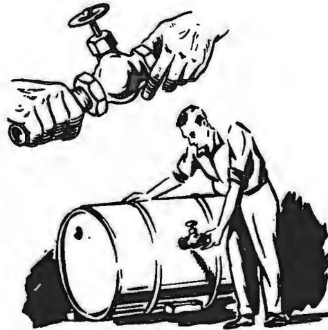
Abbildung 3-6 Fassarmatur montiert
