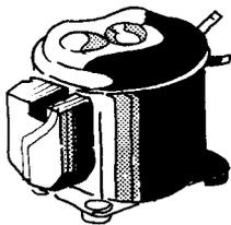
Beim hermetischen Verdichter für Kleinstleistungen sind Verdichter und Antriebsmotor in einer Einheit zusammengebaut.
