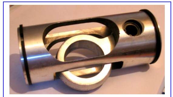
Doppelkolben des Verdichters H1-20, Durchmesser 55 mm
