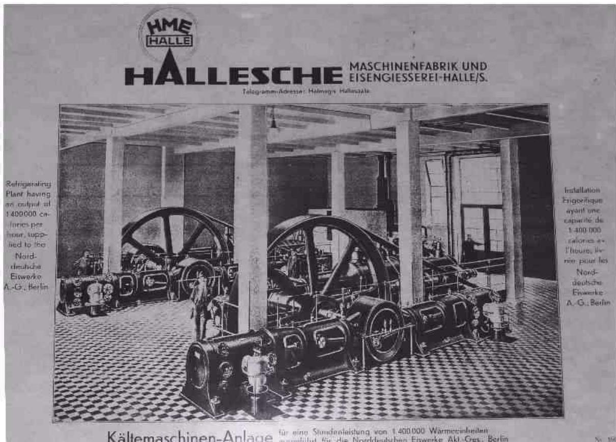
Kältemaschinen-Anlage zur Eiszerzeugung für die Norddeutschen Eiswerke AG Berlin 1914
