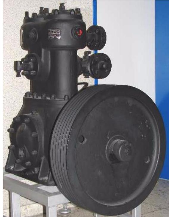
NH<sub>3</sub> Verdichter der Linde AG Wiesbaden, Typ RS 30, Baujahr 1936, Drehzahl 750 min<sup>-1</sup>, Kälteleistung 40 kW bei 10/+35 °C
