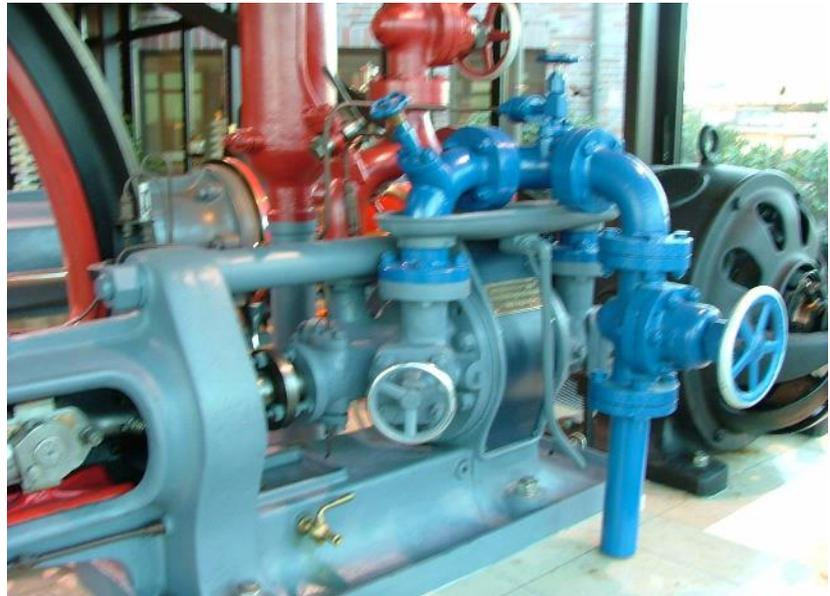
Antrieb durch Einzylinder-Dampfmaschine mit Lenzsteuerung, MAN AG, Nr. 4838 und Dynamo zur Stromerzeugung, Siemens-Schuckert, Type IF2819/750, Baujahr 1915. - Die Anlage stammt von der Brauerei Turn & Taxis in Schierling und war dort bis 1982 in Betrieb.
