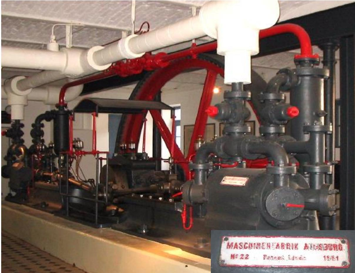
Verdichterdaten: Tandemverdichter liegend, offen, doppelwirkend, Zylinderdurchmesser 325,6 mm, Hub 540 mm, Drehzahl 60 U/min. - Die Anlage wurde zu Beginn zur Eiserzeugung eingesetzt mit einer Leistung von 66540 kg in 20 Stunden – später wurde sie zur Raumkühlung verwendet.
