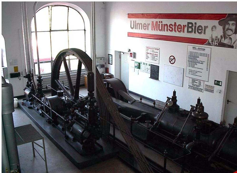
Der Linde Tandemverdichter hat die Lfd, Nr. 6223 und 6224 und wurde 1907 von MAN hergestellt – Hub 420 mm, Zylinder  $\phi$  250 mm, Kältemittel  $\text{NH}_3$ , Kälteleistung  $2 \cdot 158$  kcal/h bei  $-10/+25^\circ\text{C}$ . – Dampfmaschine MAN 1907, Leistung 150 PS.
