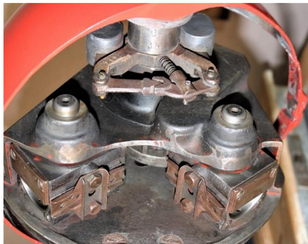
Bild 8: Fliehkraftregler zur Anlaufentlastung und die beiden Zylinder
