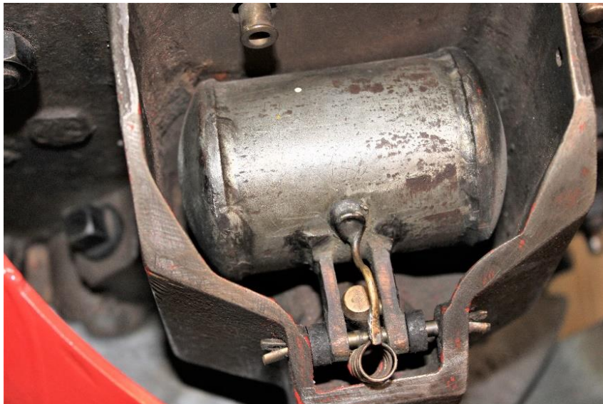
Bild 5: Hochdruckschwimmer zur Einspritzregelung
