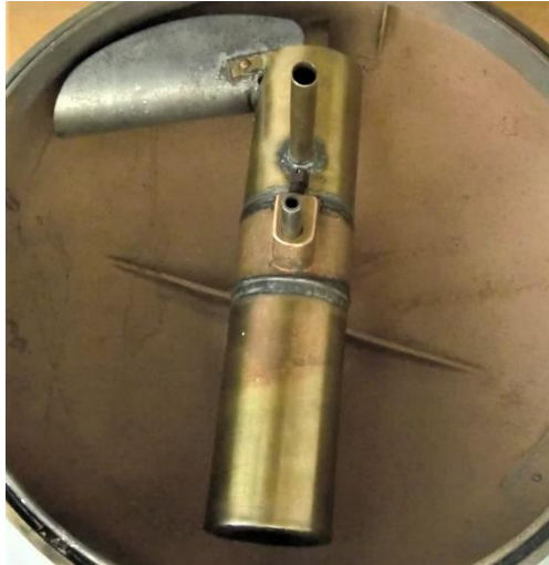
Bild 7: Ölrückführung aus der Verdampferkapsel
