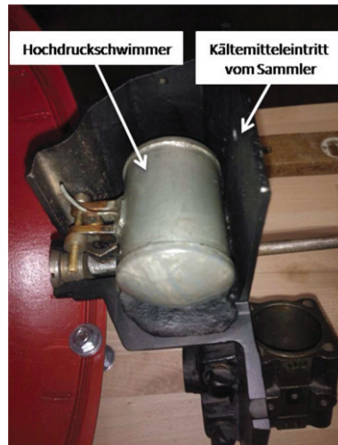
2:8 Hochdruckschwimmer im Inneren der roten Kugel
