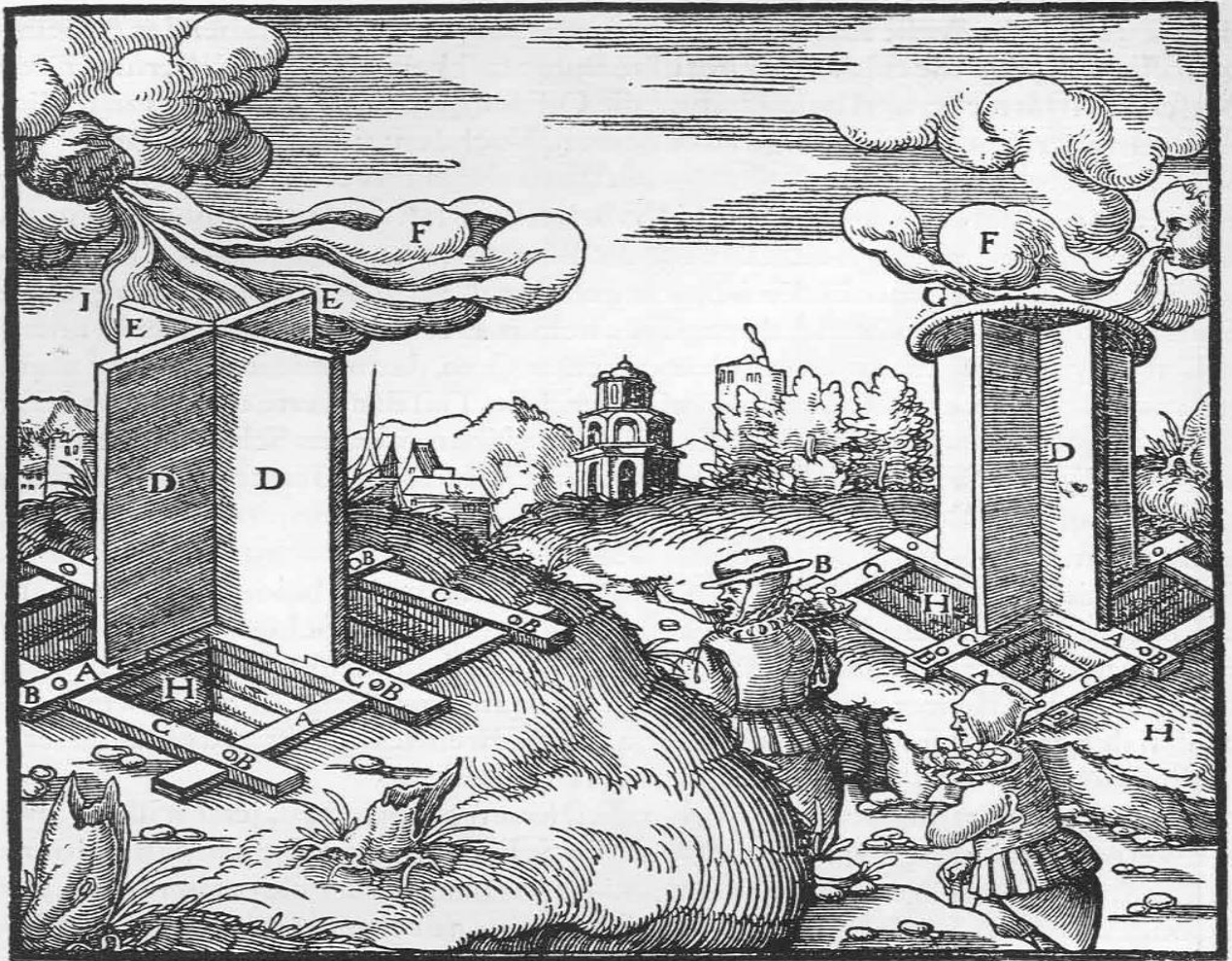
Die Hölzer A. Die zugespitzten Pfähle B. Die Querhölzer C. Die Bretter D. Die Hohlräume E. Der Wind F. Der Deckel G. Der Schacht H. Die Vorrichtung ohne Deckel I.
