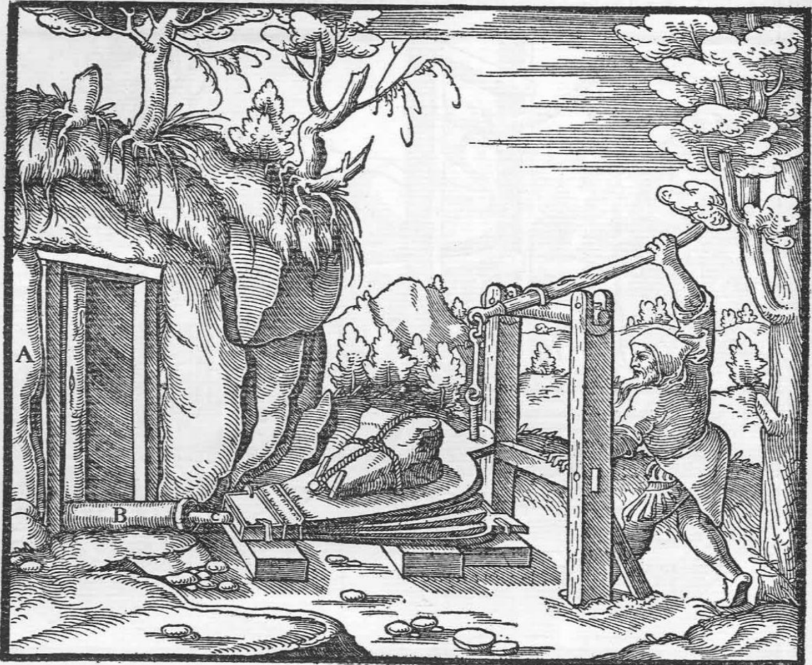
Der Stollen A. Die Rohre B. Das Mundstück des doppelt wirkenden Blasebalges C.
