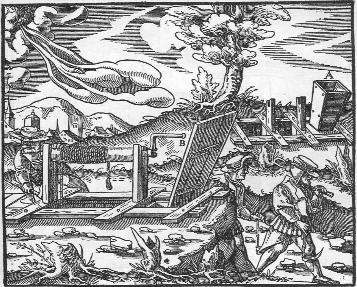
Die herausragende Luttenöffnung A. Die an die nicht herausragende Lutte angeschlagenen Bretter B.
