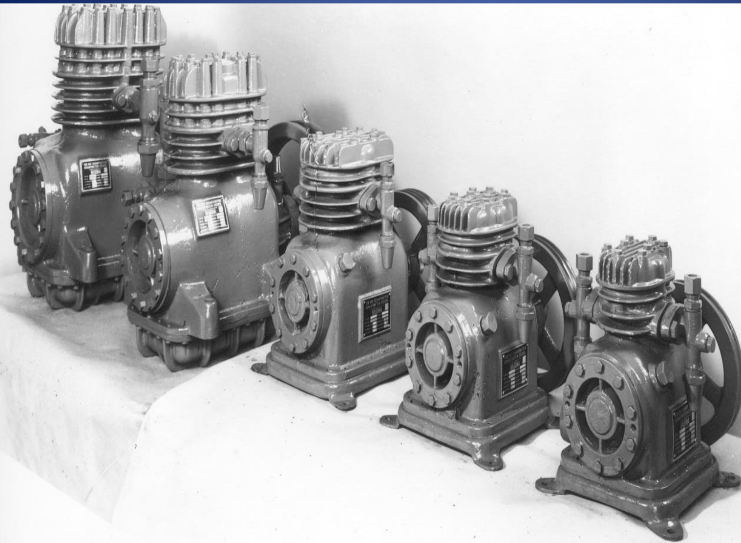
DKK Hubkolben Kompressoren K 352 bis K 1202 von 1939
