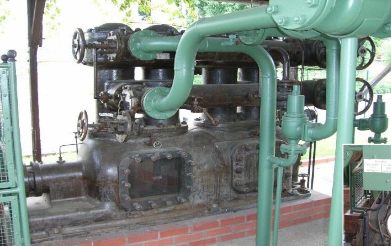
Kältemaschine mit zweistufigem 4-Zylinder NH 3 -Gleichstromverdichter von Borsig, Baujahr 1938. Die Anlage diente zur Solekühlung für eine Butadien-Destillation im Bunawerk Schkopau.
