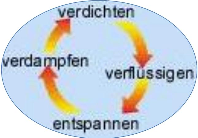
Drosselstelle, in der das Kältemittel von dem hohen auf einen niederen Druck entspannt wird
