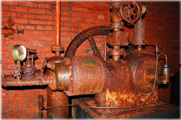
liegender Kolbenverdichter, der den Kältemitteldampf ansaugt und auf einen höheren Druck verdichtet
