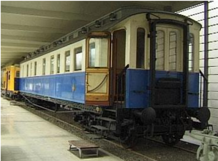
Salonwagen der Kaiserin Auguste Victoria (1911) Kokszentralheizung, Kühlung durch Wasser, das auf ein Segeltuch gesprüht wurde
