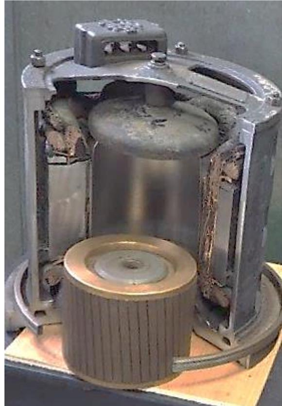
**Der Rotor** treibt eine zentral gelagerte Welle mit Exenterszapfen und damit den **Verdichter** im Kurbelgehäuse.
