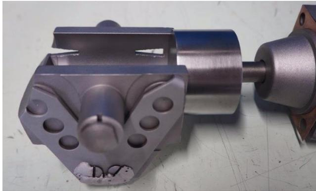
Dann sind auf der Gegenseite des Zylinders 2 Bohrungen sichtbar, Das sind die Druckgasauslässe, von außen mit stabil gesicherten Rückschlag-Flapperventilen bestückt.
