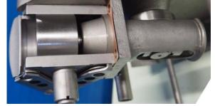
**Bild:** Kurbelzapfen mit Gleitstein und aufgeschnittenem Zylinder - mit Doppelkolben und Schwenkzapfen.
