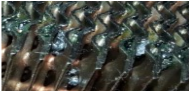
Bild 2: total Verschmutzter Platten-WT.
