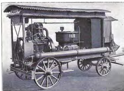
Fig. Nr. 37 Fahrbare Kompressoranlage mit Benzolmotorantrieb
